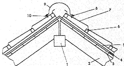
Coama se montează la intersecția a două planuri (ape) în care acestea formează îmbinare exterioară. Pentru asigurarea bunei circulații a aerului și corespunzător ventilării spațiului dintre țigla metalică și folia anticondens trebuie să se țină cont de faptul că panourile de țigla metalică **NU TREBUIE SĂ SE UNEASCĂ** la îmbinările de coamă.
