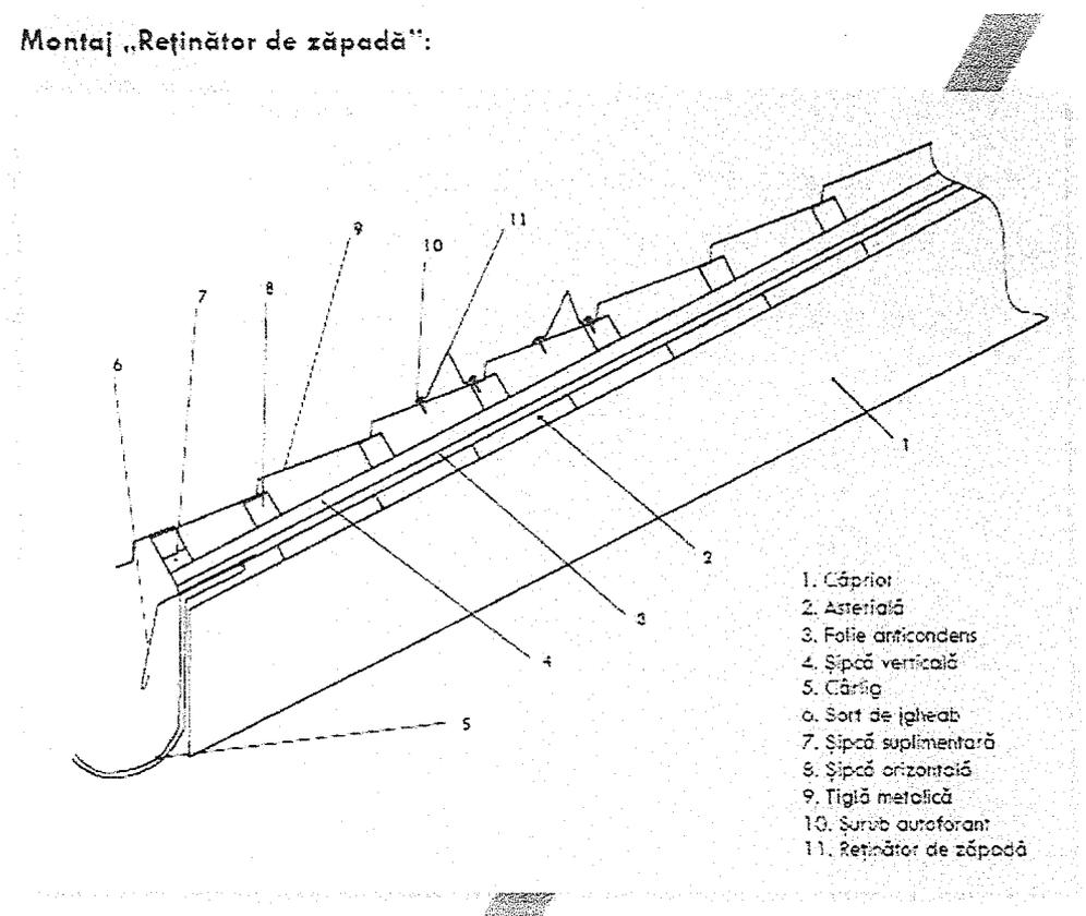
Pentru prevenirea alunecării zăpezii de pe acoperiș în vederea protejării jgheaburilor și evitarea traumatizării oamenilor se montează REȚINĂTORII DE ZĂPADĂ. REȚINĂTORUL DE ZĂPADĂ se montează la o distanță de aproximativ 1m - 1,5 m de streășină, adică la al treilea și al patrulea modul al panoului de țiglă metalică.
